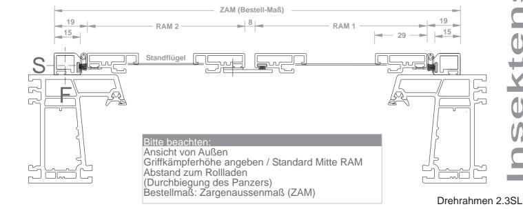
Slim-Door mit Montageprofil - Sonder-Lösungen mit Anschlag-Blech
