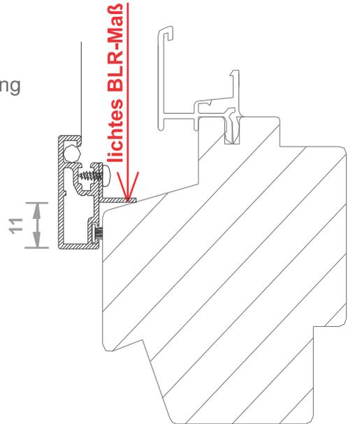
Ist eine Regenschutzschiene mit Stockabdeckung vorhanden, wird das Insektenschutzgitter auf die Stockabdeckung aufgesetzt (unten abgedichtet durch ein 3 mm starkes Dichtband). Beschlagsvariante 235.2 / 236.2.
