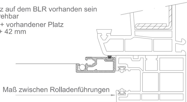
Sonder-Fall für sehr eng montierte Rollladenführungen
